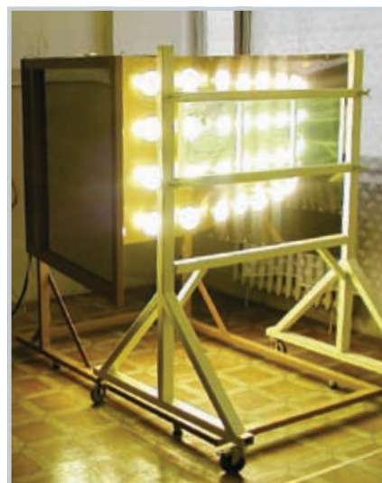
Fot. 7. Stanowisko do badania odporności szkła warstwowego na działanie promieniowania
