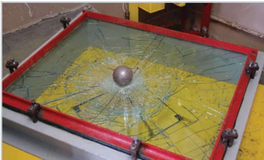
Fot.10. Fragment stanowiska do badania wytrzymałości na uderzenie kulą o masie 4,11 kg
