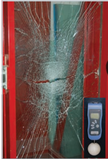
Fot. 9. Rozdarcie folii w szkłe warstwowym i przyrząd do badania wielkości rozdarcia
