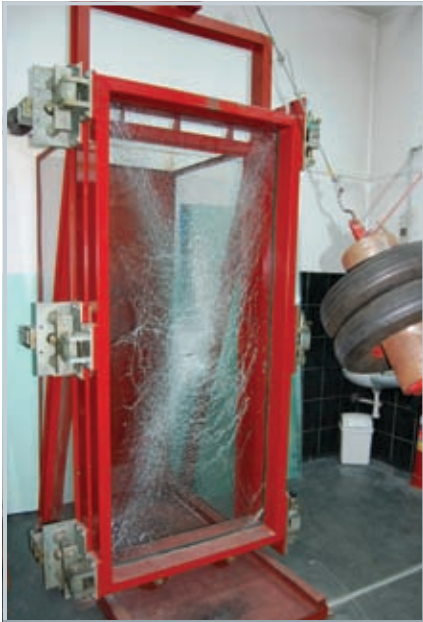
Fot. 8. Stanowisko do badania wytrzymałości na uderzenie wahadłem z oponami.
