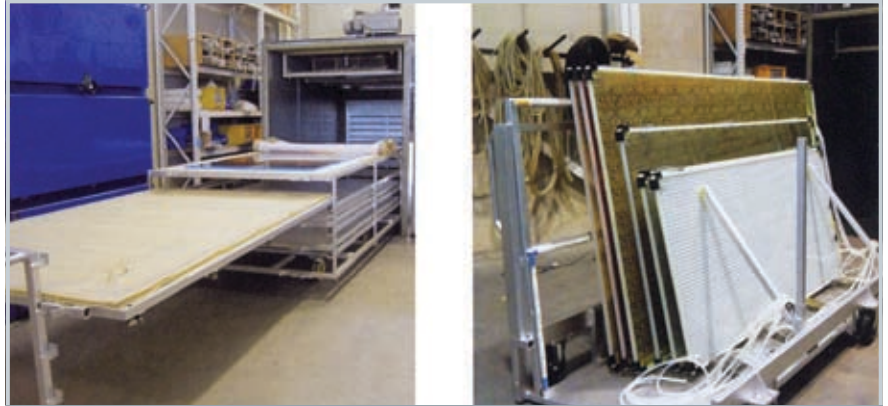
Uniwersalny piec do laminowania folii EVA. Produkty można wkładać do pieca poziomo i pionowo.
