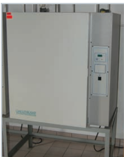
Fot. 5. Ciepłarka do badania odporności szkła warstwowego na działanie wysokiej temperatury
