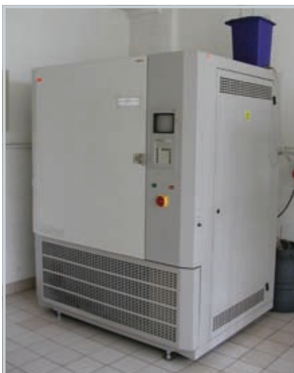
Fot. 6. Komora chłodnicza do badania odporności szkła warstwowego na działanie wilgoci
