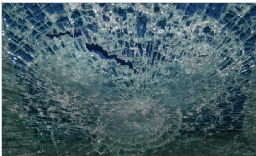
Fot. 11. Spękana szyba po uderzeniu ją kulą o masie 4,11 kg
