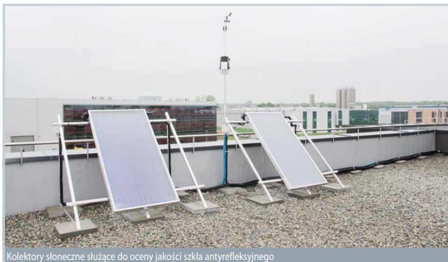
Kolektory słoneczne służące do oceny jakości szkła antyrefleksyjnego
