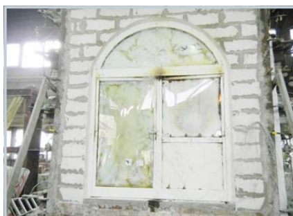
Fot. 3. Widok nienagrzewanej powierzchni drewnianych drzwi dwuskrzydłowych z nadświetłem w kształcie łuku, o deklarowanej odporności ogniowej EI1 60 po badaniu w zakresie odporności ogniowej (źródło: Archiwum ITB)
