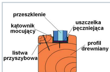
Rys. 7. Przekrój przez przykładowy profil drewniany, ściany działowej lub drzwi [27]
