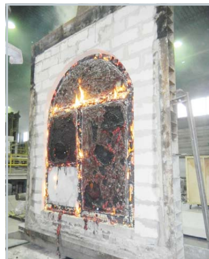
Fot. 4. Widok nagrzewanej powierzchni drewnianych drzwi dwuskrzydłowych z nadświetłem w kształcie łuku, o deklarowanej odporności ogniowej EI1 60 po badaniu w zakresie odporności ogniowej (źródło: Archiwum ITB)
