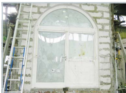
Fot. 2. Widok nienagrzewanej powierzchni drewnianych drzwi dwuskrzydłowych z nadświetłem w kształcie łuku, o deklarowanej odporności ogniowej EI1 60 w 31 minucie badania w zakresie odporności ogniowej (źródło: Archiwum ITB)
