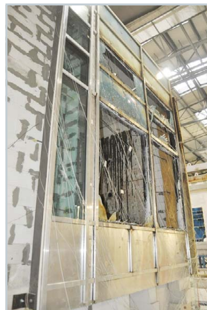
Fot. 5. Widok nienagrzewanej powierzchni stalowej ściany osłonowej, o deklarowanej odporności ogniowej EW 60 przed badaniem w zakresie odporności ogniowej (źródło: Archiwum ITB)
