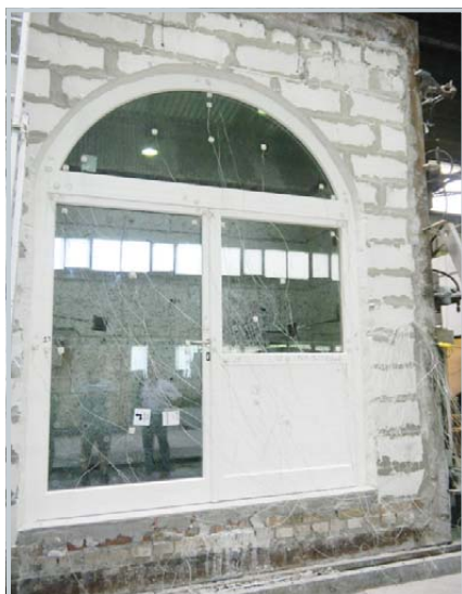
Fot. 1. Widok nienagrzewanej powierzchni drewnianych drzwi dwuskrzydłowych z nadświetłem w kształcie łuku, o deklarowanej odporności ogniowej EI1 60 przed badaniem w zakresie odporności ogniowej (źródło: Archiwum ITB)
