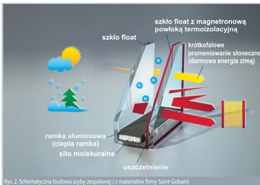
Rys. 2. Schematyczna budowa szyby zespolonej (z materiałów firmy Saint-Gobain)
